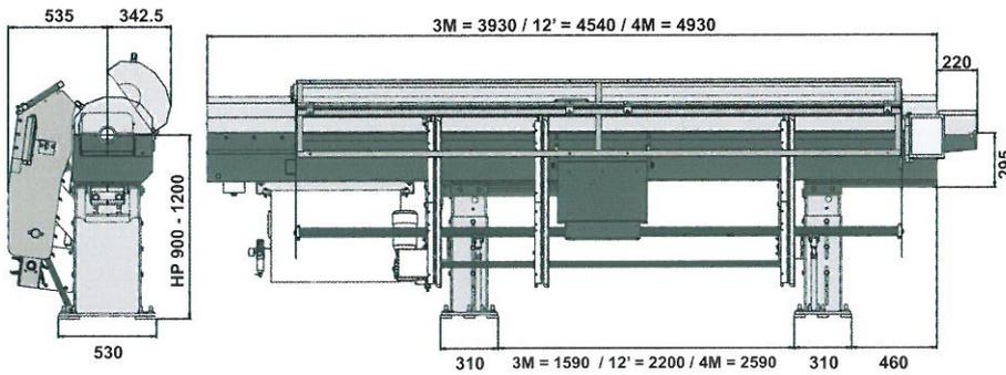
**Diametro delle barre Sprint 552** ø 5 - 52 mm
